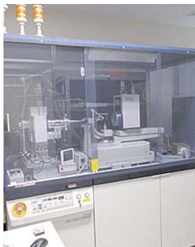
CCD单結晶自動X線構造解析装置 (Rigaku)
