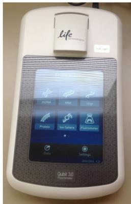
ライブラリ調製のために、蛍光色素による DNA・RNA 定量を行う装置です。吸光度法よりも正確に定量できます。他に、タンパク質・コレステロール・ブドウ糖を定量することも可能です。初期ユーザーには DNA・RNA・タンパク質用の試薬と専用チューブを提供します。
