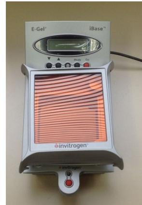
ライブラリ調製のために、特定サイズの DNA・RNA 断片の分離・回収を行う装置です。
